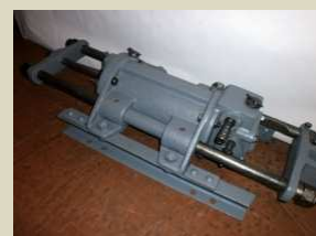
Vzduchový žľabový motor pred a po reštaurovaní
