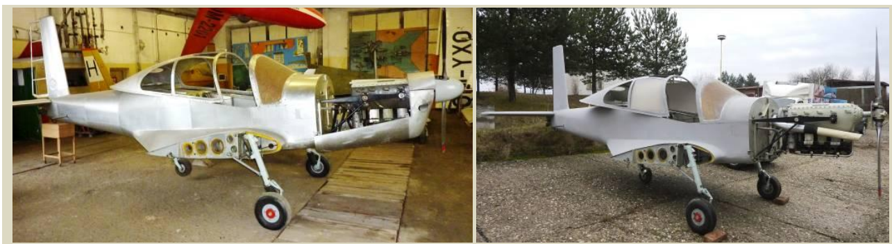
L-40 Meta Sokol – reštaurovanie plášťa a prekrytu kabíny
