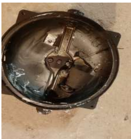
Vyhoretý kryt svetidla a spálený strop, havarijný stav rozdeľovača káblov (suterénne depozity kníh, Hlavná) pred opravou
